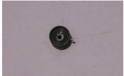
**Figura:** Apertura pequeña colocada a la entrada del tiro. Se utilizó un diafragma con apertura variable entre 1 y 12 mm.
